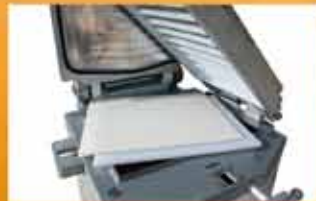
Aluminium omkadering met vette aandrukplaat en vilt
